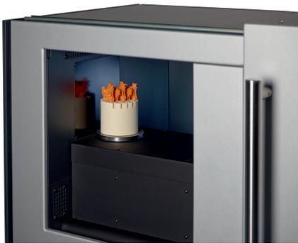
Messung von mehreren Werkstücken in einem Arbeitsgang mit dem TomoScope XS FOV 500. © Werth Messtechnik
